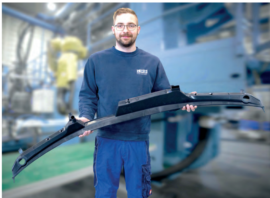
Bild 1. Ein Beispiel für lange schmale 2K-Automobilkomponenten ist die „Wasserkastenblende“, die den Bereich vor der Windschutzscheibe über die gesamte Fahrzeugbreite abdeckt © LWB Steinl
