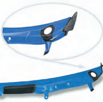
Bild 2. Das Formteil wird aus zwei Thermoplast-Komponenten gefertigt: Der Hauptkörper aus Polypropylen ist an den Anlagestellen zur Karosserie und in den Durchgangsbereichen für die Scheibenwischer mit elastischen TPE-Partien kombiniert © Eldisy
